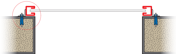
แบบติดตั้งหลบเสา (ติดบวก)
